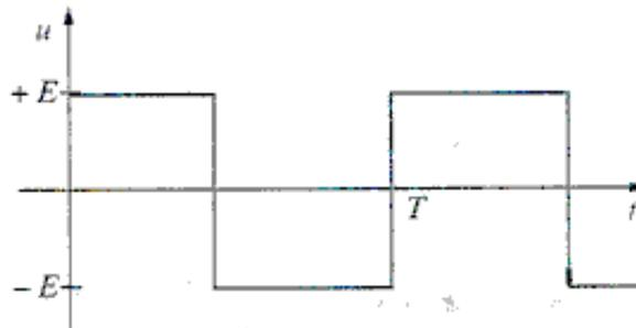
Figure 10.10. On pose  $\omega = \frac{2\pi}{T}$  : c'est la pulsation du fondamental
